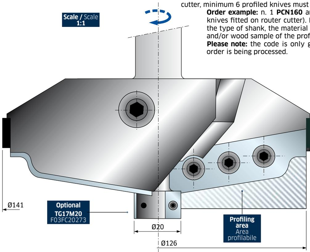
Per la profilatura di legni naturali teneri e duri, legni esotici, truciolari e MDF su pantografi normali o CNC. Nel codice **PCN160** è compreso il corpo punta, n. 2 coltelli profilati a disegno, viti e chiavi di servizio. Per ogni singola punta devono essere ordinati almeno 6 coltelli profilati.
