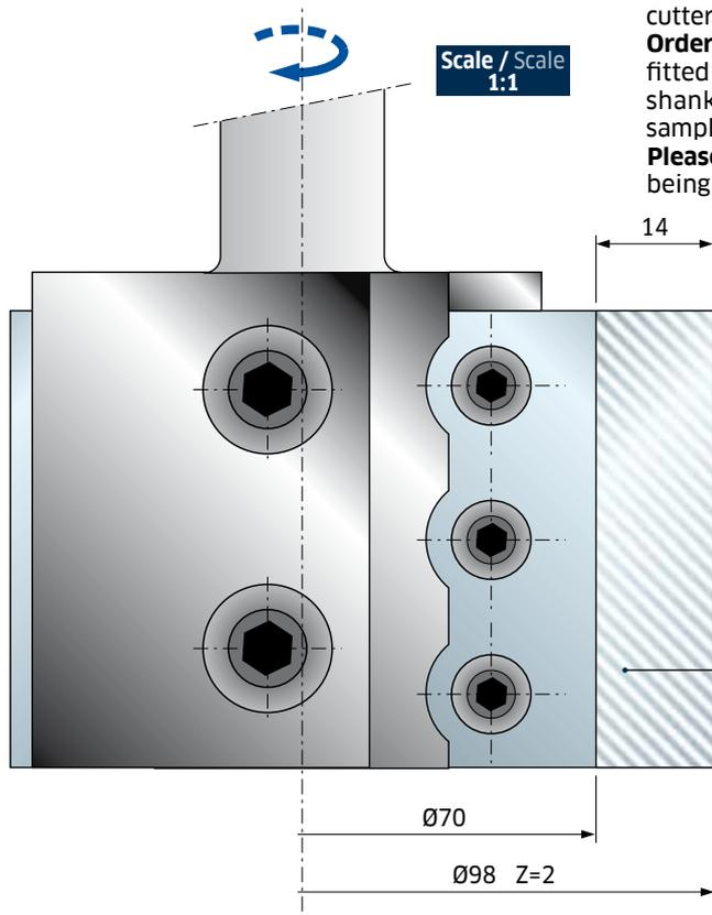
Per la profilatura di legni naturali teneri e duri, legni esotici, truciolari e MDF su pantografi normali o CNC. Nel codice **PCN130** o **PCN130CM** è compreso il corpo punta, n. 2 coltelli profilati a disegno, viti e chiavi di servizio. Per ogni singola punta devono essere ordinati almeno 6 coltelli profilati.
