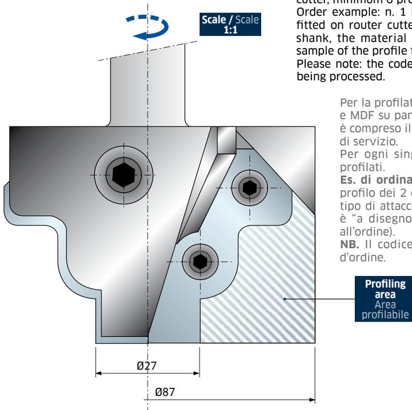
Per la profilatura di legni naturali teneri e duri, legni esotici, truciolari e MDF su pantografi normali o CNC. Nel codice **PCN140** o **PCN140CM** è compreso il corpo punta, n. 2 coltelli profilati a disegno, viti e chiavi di servizio.
